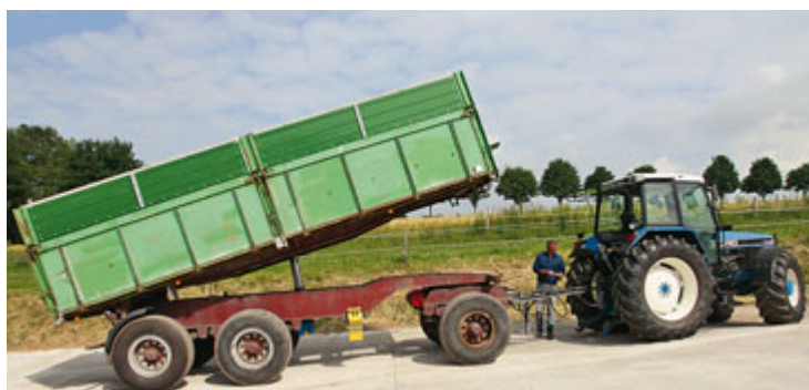
Wenn man versehentlich den Kipper mit angehobener Brücke abgehängt hat, kann man sie mit dem ÖldruckMaster absenken, man braucht dafür aber Geduld.
